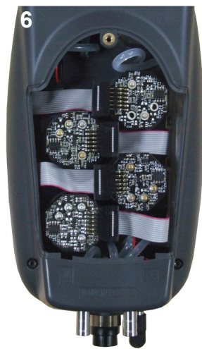
Connexion de la nappe et de la cellule
